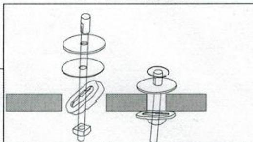
Procedere con l'inserimento del coprivaso sul sanitario. Far passare la vite B con la levetta Horizon D ed il dado E, fino a che la Rondella Piatta C non appoggia completamente sulla ceramica.
