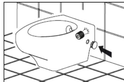
**Nel caso di accesso laterale. Verificare che sia presente un foro laterale in corrispondenza del fissaggio da Ø 20,5 mm a Ø 22 mm per la compatibilità del tappo di copertura**
