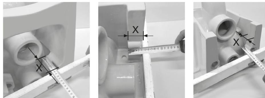
**Verificare che sia presente una rientranza di almeno 1 mm tra la superficie in appoggio al muro e la sede del fissaggio**
