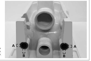
Ruotare i fissaggi WB9 B lateralmente fino a che l'inserto filettato sia raggiungibile attraverso il foro laterale del sanitario (A). Se il sanitario non ha fori laterali, ruotare i WB9 B fino a che l'inserto filettato sia rivolto verso l'alto (B).
