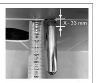
Avvitare i cannotti fino alla misura corretta, pari a spessore della ceramica  $^{\prime}$ X' - 33 mm.
