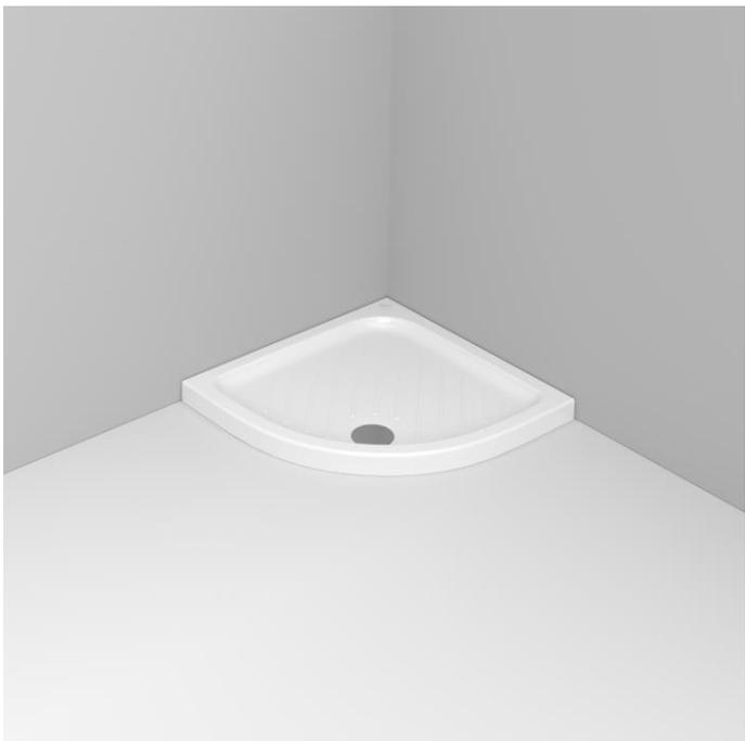
Piatto doccia in ceramica angolare alto 70 mm con disegno antiscivolo. Da completare con piletta sifonata da 90 mm. Foro di scarico posizionato nella parte frontale.
