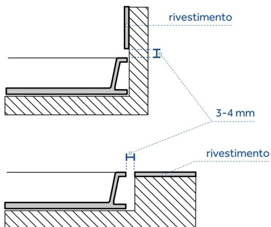
Allargare il piatto doccia tenendo conto dello spessore del rivestimento a parete (o al suolo in caso di installazione filo pavimento) e lasciando uno spazio di 3-4 mm.
