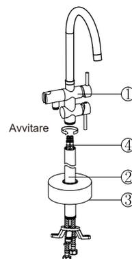
2. Utilizzare la chiave esagonale per fissare il corpo del miscelatore alla colonna, attraverso l'apposita vite.
