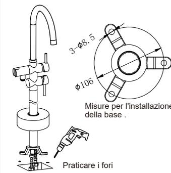
7. Fissare il miscelatore al pavimento con le apposite viti di fissaggio, accertandosi che siano idonee alla pavimentazione presente.
