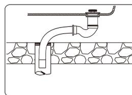
Collegare il troppo pieno alla piletta, e successivamente collegare il sifone (non compreso). Allacciare l'impianto realizzato allo scarico, ed effettuare delle prove di tenuta. Si consiglia il montaggio da parte di personale qualificato.
