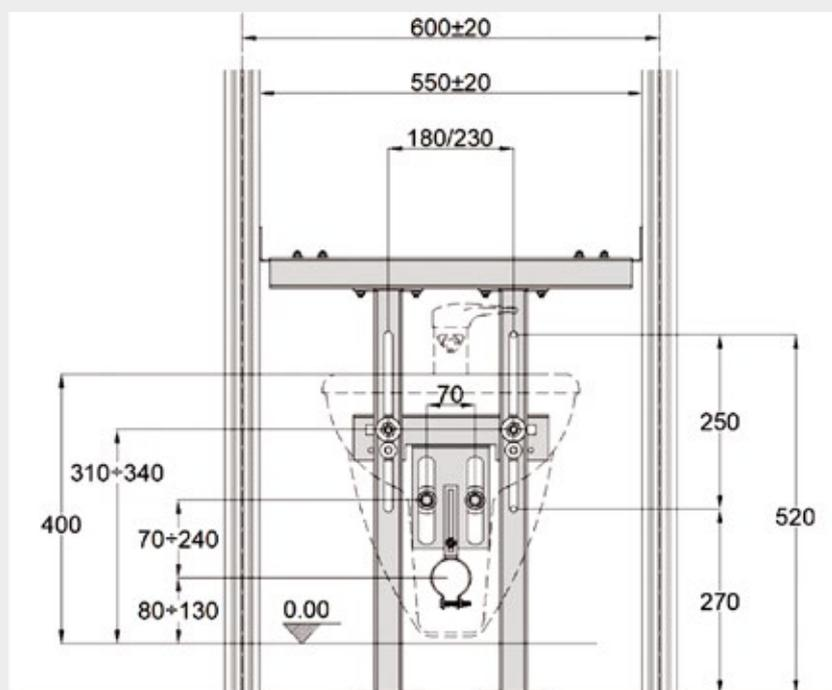
Il supporto è in acciaio zincato DX51D + Z 275 secondo EN10346:2009. La bulloneria è zincata secondo UNI EN ISO 898-1:2012 (bulloni e barre filettate) e 898-2:2012 (dadi esagonali). Il supporto singolo pesa 7,3 kg.
