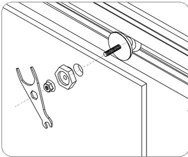
Svitare i componenti delle rotelle precedentemente infilate nel profilo per il montaggio delle porte.
